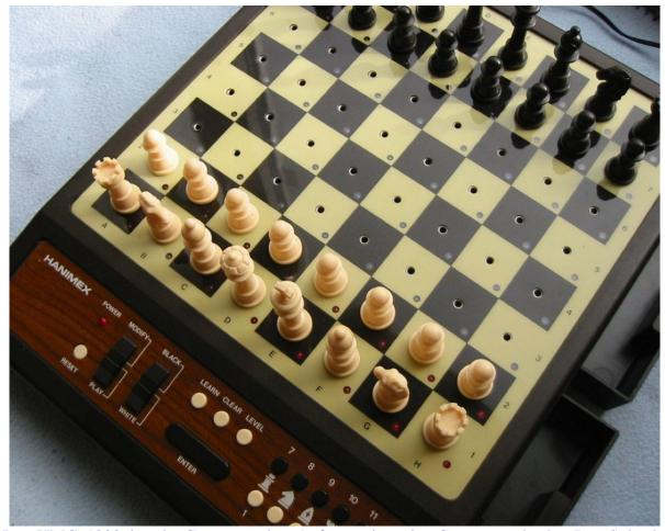
Der HMG 1200 ist ein Gerät aus den Anfangszeiten des Computerschachs. Der Schachcomputer besitzt ein vergleichsweise riesiges Steck-Sensorbrett, dessen 64 Feld-LED's auch dazu dienen, die gewählte Spielstufe anzuzeigen. Aber dazu werden nicht einfach die LED's der Felder A1-B4 o. ä. verwendet, sondern die Zahlen von 1-12 werden als Ziffern dargestellt.
