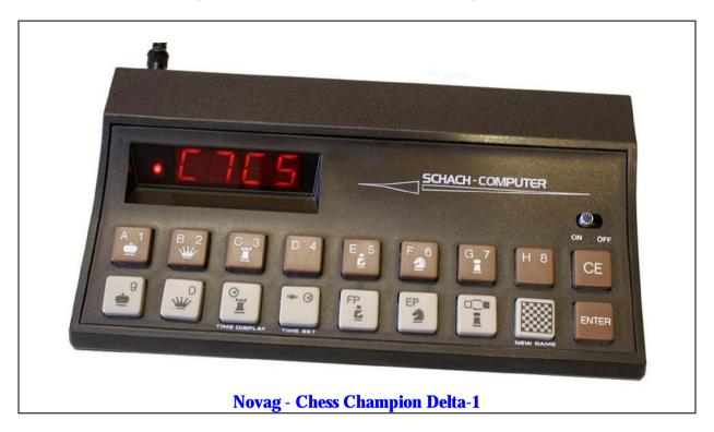
**Delta-1** ist ein Schachcomputer aus den 80-er Jahren, den es auch unter der schlichten Bezeichnung "**Schachcomputer**" gibt. Die Bedienung dieses netzgespeisten und mit einer vierstelligen rotleuchtenden Siebensegment-LED-Anzeige ausgerüsteten Geräte hat viele Gemeinsamkeiten mit anderen Geräten der Chess-Champion-Reihe. Die Spielstärkeeinstellung geschieht durch Rechenzeitvorgabe im Bereich von einigen Sekunden bis zu 100 Stunden.
