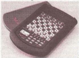
Die Spannungsversorgung erfolgt ausschließlich über 3 Batterien vom Typ AAA 1,5 V MICRO; nach Angaben des Herstellers soll dieser Satz bei Alkali/Mangan für rund 300 Stunden Spielbetrieb gut sein.
